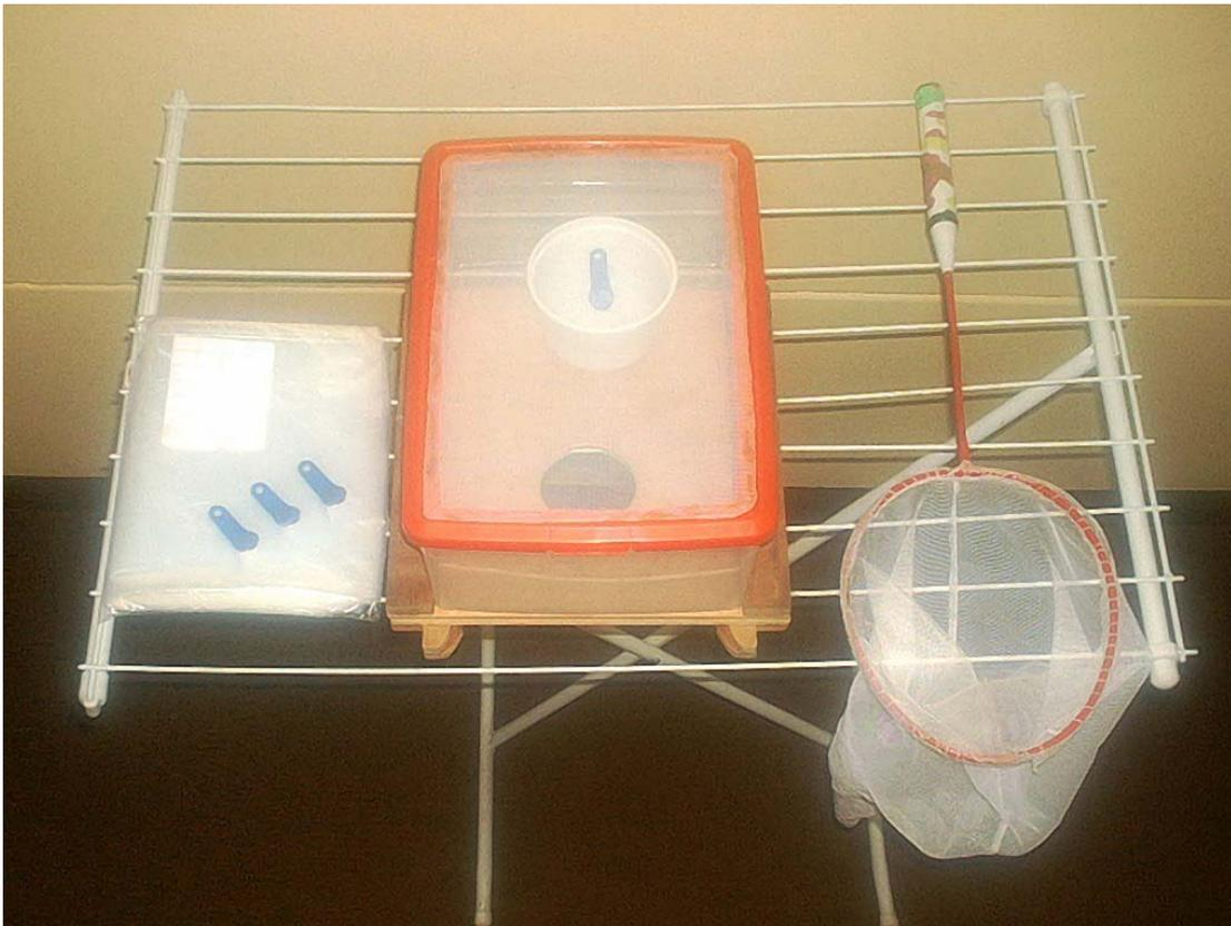
**Figura 4:** Bastidor con caja de cultivo, pocillo con sensor electrónico, bolsas de plástico, etiquetas autoadhesivas con 3 sensores, utilizados para los cultivos y malla entomológica, para la captura de *H. irritans*.
