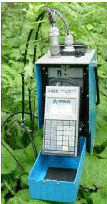
Figura 5. Sonda de neutrones (Troxler 4300)
