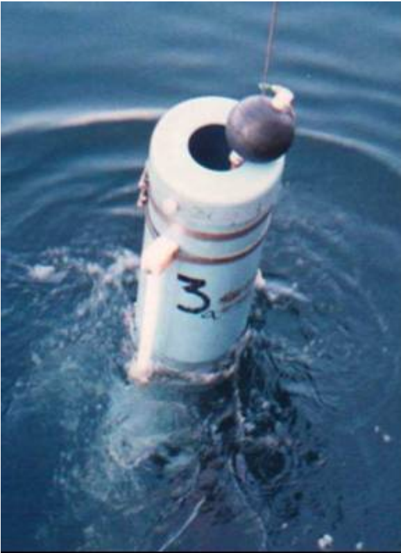
Figura 2: Botella oceanográfica de 30 l utilizada para el muestreo de biomasa de pellet fecales y microplancton en la columna de agua.
