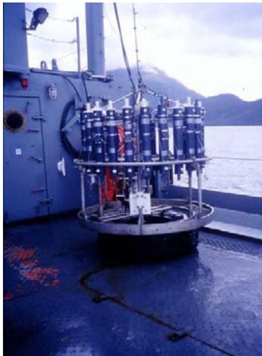
Figura 15. Roseta oceanográfica con 24 botellas niskin de 3 litros.
