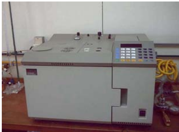
Figura 10. Cromatógrafo de gas, Perkin-Elmer, modelo 9000.
