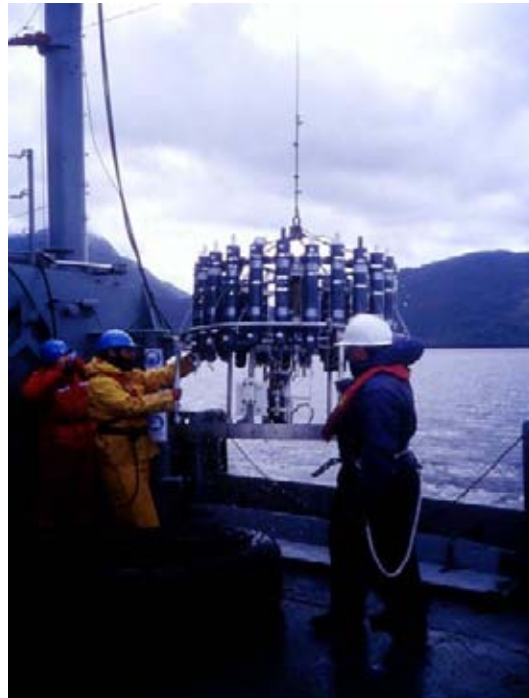
Figura 14. CTD y Roseta para obtención de muestras de agua utilizadas durante el embarque.
