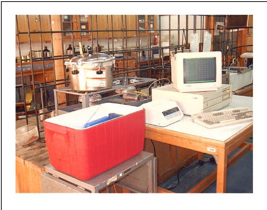
FIGURA 6. Montaje del ensayo con el sistema de calentamiento, enfriamiento y registro de datos
