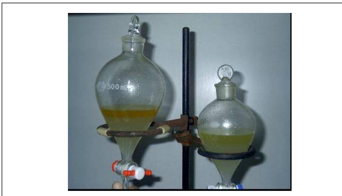
FIGURA 11 Separación de las dos fases en la extracción del caroteno. La fase etérea conteniendo los carotenos y la fase acuosa con acetona.
