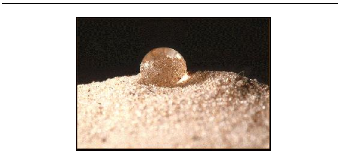
FIGURA 2 Forma que toma la gota de líquido sobre un sólido repelente.
