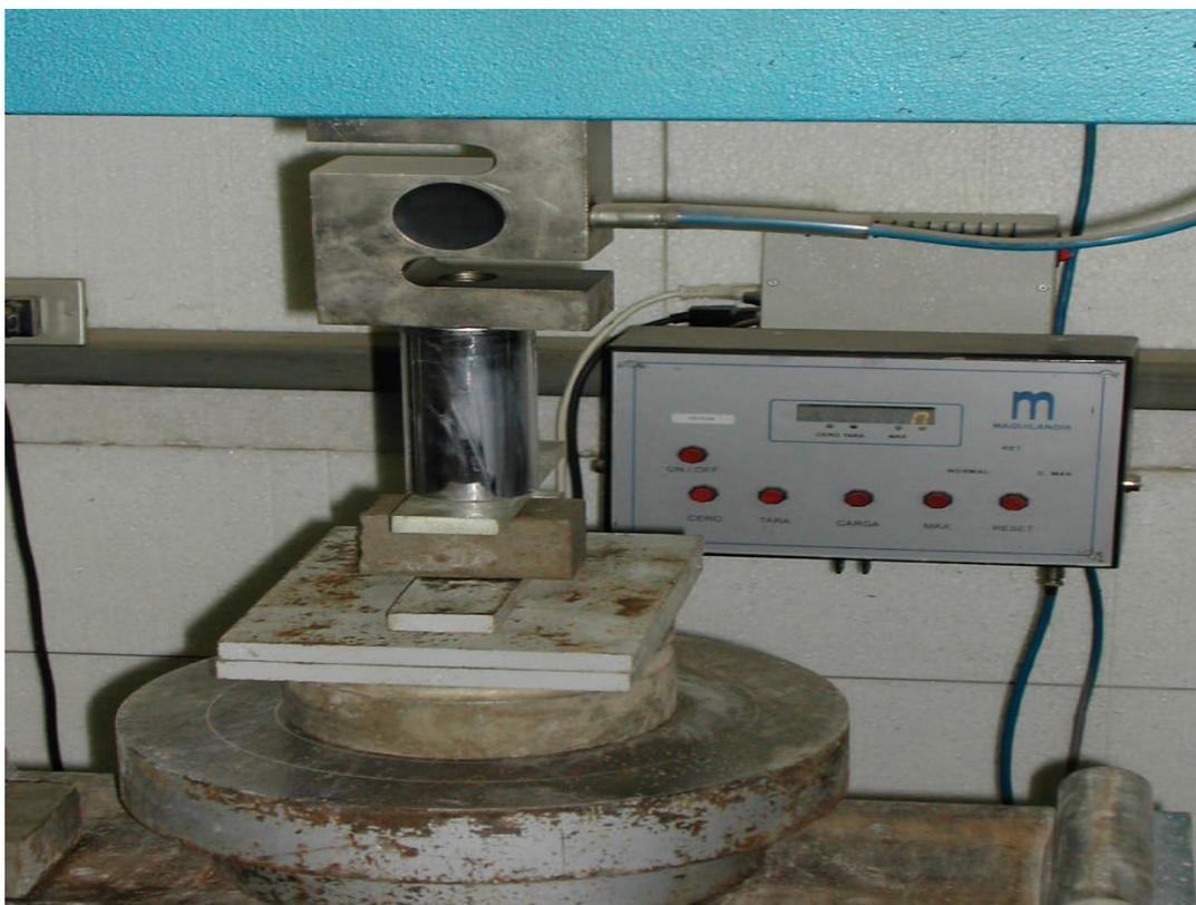
Fotografía 6.9. ENSAYO A COMPRESIÓN
