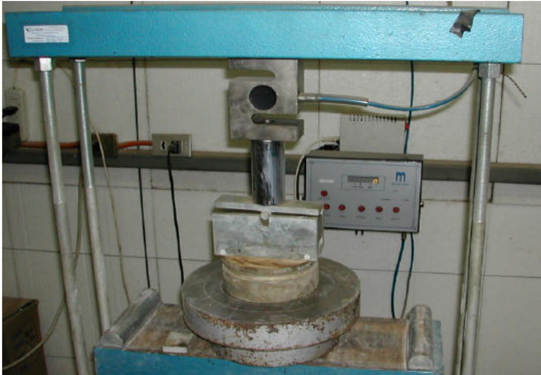
Fotografía 6.8. ENSAYO A FLEXIÓN
