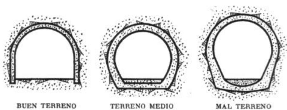
Fig. 2.04 Secciones transversales de túneles para vías férreas
