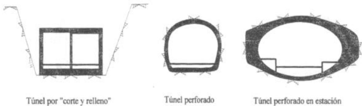
Fig. 2.09 *Distintas secciones para dos vías*
