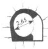
Túnel con tubería forzada
