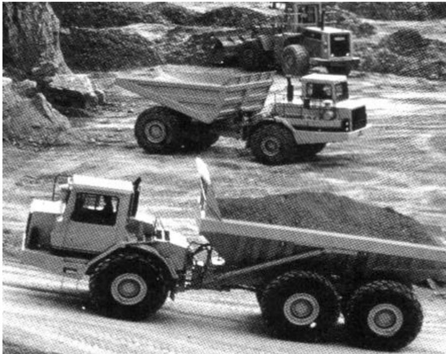
Fig. 3.27 *Dumper y pala excavadora (al fondo)*
