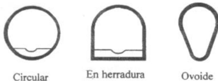
Fig. 2.13 Secciones tipo
