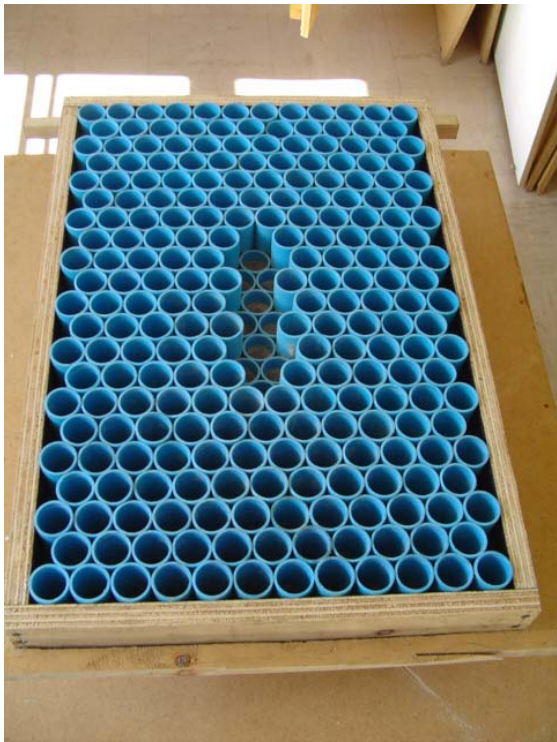
Fig. 8.2.- Silenciador 2. (a) Bosquejo de las medidas geométricas que caracterizan al silenciador 2. (b) Se observan los resonadores de \lambda/4 más la ranura por donde atraviesa el disco de sierra. (c) Se observa el silenciador 2 desde otro ángulo.
