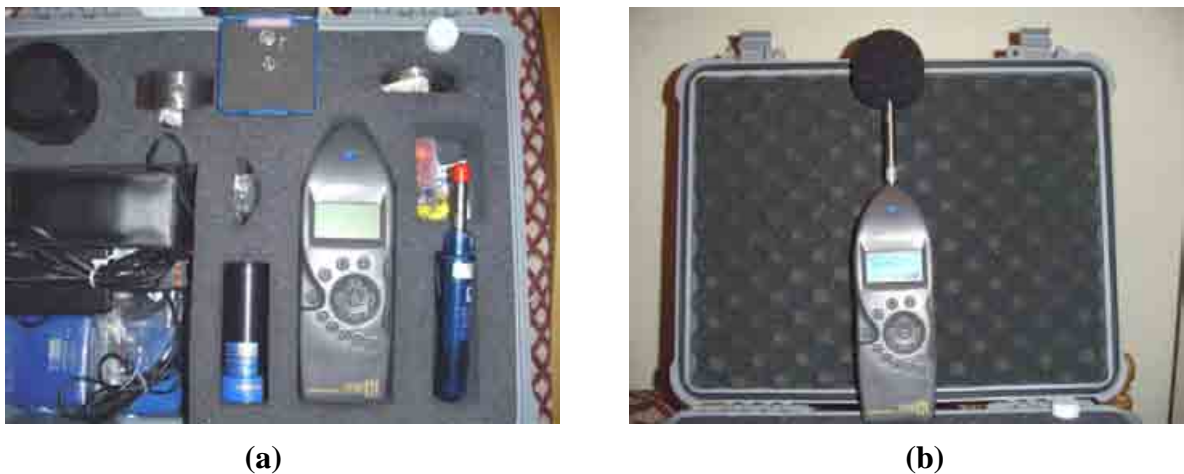
Fig. 5.2.- Sistema de medición Larson Davis 824. (a) Componentes del sistema: sonómetro, micrófono, preamplificador, calibrador y otros. (b) Sistema de medición armado.
