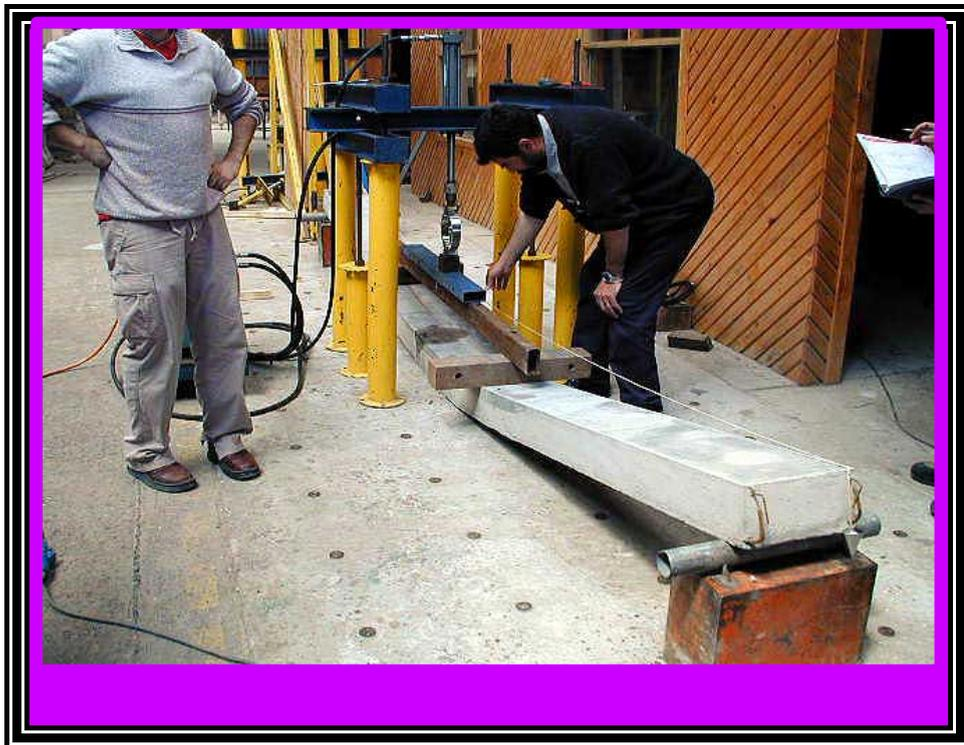
*Ensayo flexión losa*
