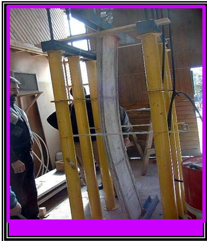
*Ensayo compresión vertical panel*
