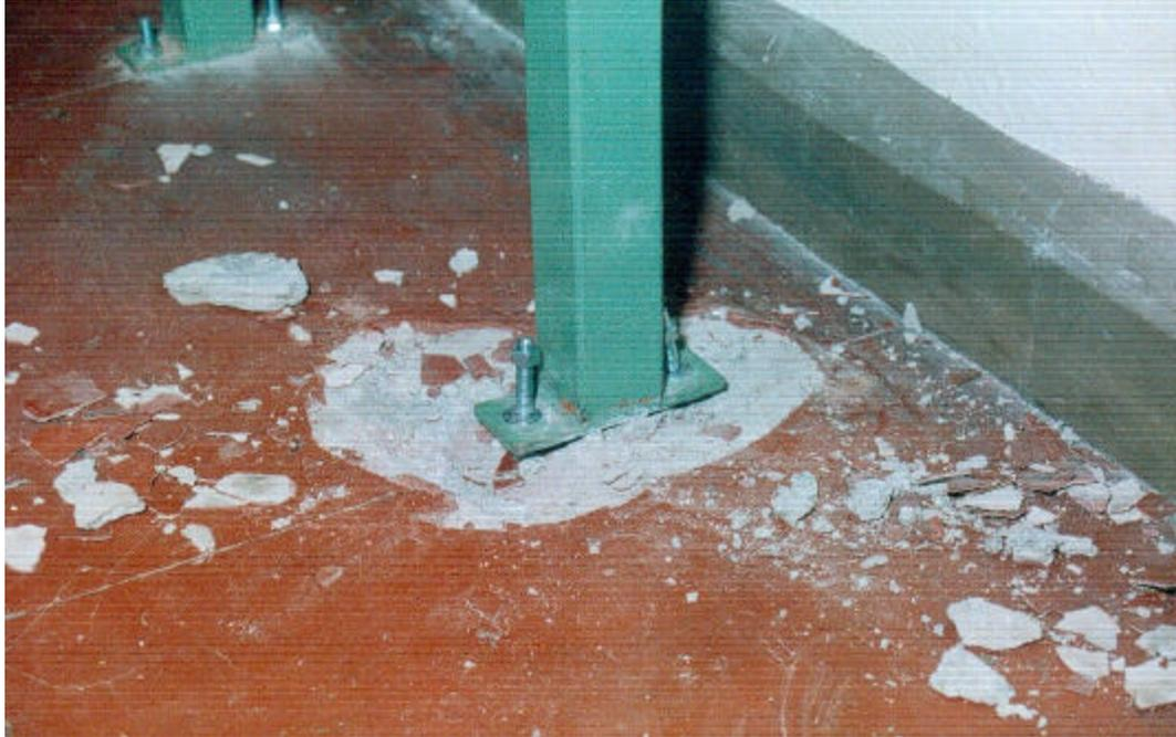
Fig. 4.2 Falla del sistema de empotramiento del banco de ensayo
