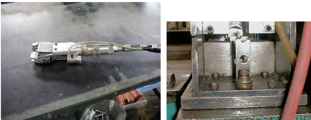
FIGURA N°6.6, Equipos con Fugas de Aceite
