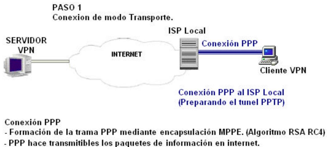
**Figura 3-6.** Conexión PPTP en modo túnel.
