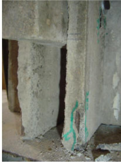
Fotografía 4.9 *Falla en patas de la Probeta*
