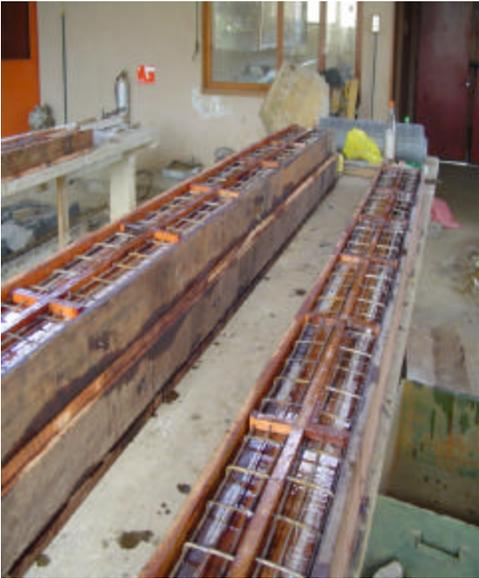
Fotografía 3.2 *Moldaje con armadura*
