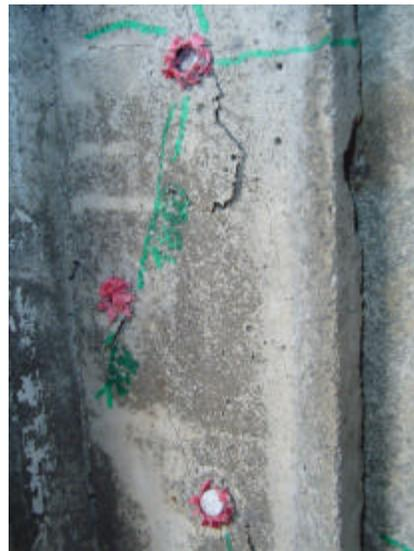
Fotografía 4.7 Fallas en probetas con Clavos Hilti
