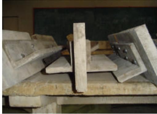
Fotografía 2.5 *Probetas con pernos*
