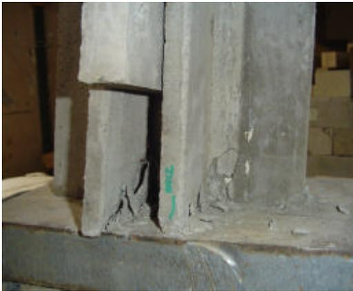
Fotografía 4.11 *Falla por excentricidad de carga*
