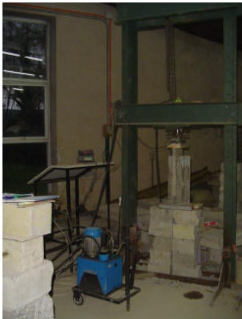
Fotografía 4.3 *Estructura de carga.*
