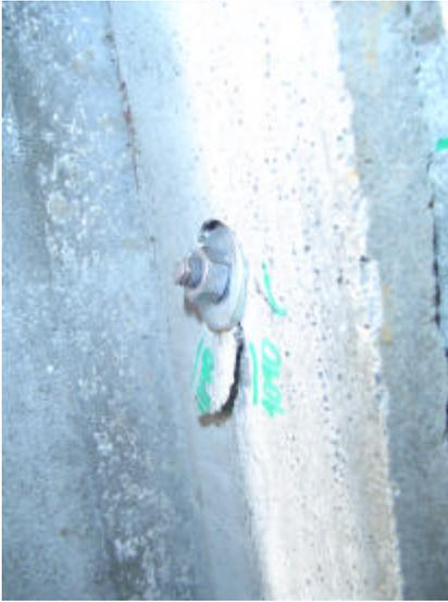
Fotografía 4.8 *Falla en probeta con Perno*
