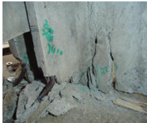
Fotografía 5.12 *Falla por excentricidad de carga*
