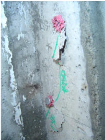
Fotografía 4.6 Fallas en probetas con Clavos Hilti
