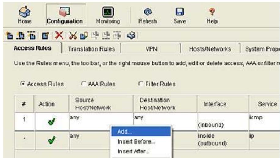
**Figura 5.24.** Agregando una regla de acceso (Outbound) usando PDM.
