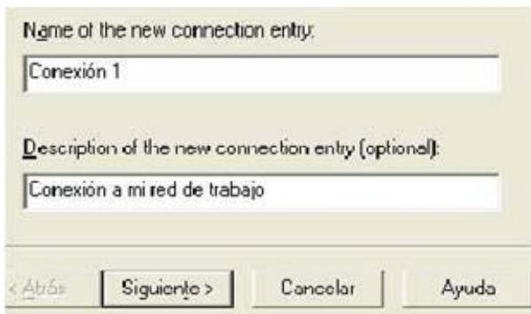
**Figura 5.17.** Ingresando texto descriptivo para la conexión VPN.
