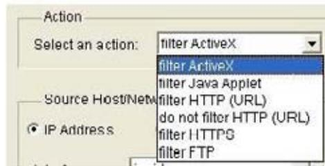
**Figura 5.37.** Vista de todas las alternativas de filtro que tiene PIX, en capas superiores.
