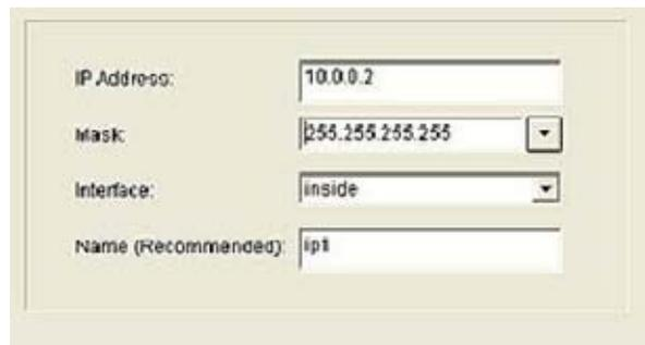
**Figura 5.31.** Configuración de cada IP que luego usaremos para identificar el host autorizado a salir a Internet.
