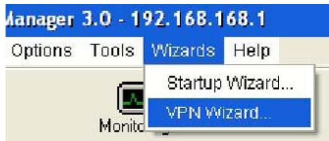
**Figura 5.7.** Abriendo el Wizard que permite configurar VPN.
