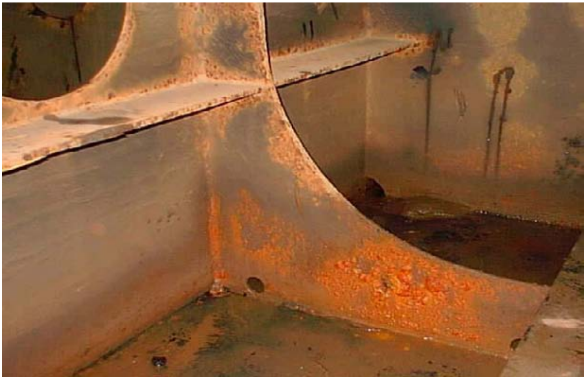
Solución recomendada para la eliminación de puntos duros en la plancha de fondo.
