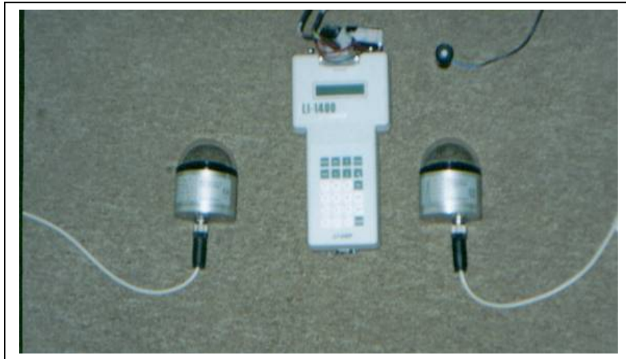
FIG. 6.06 Data logger LI-1400 y sensores. FUENTE Elaboración propia, 2004.
