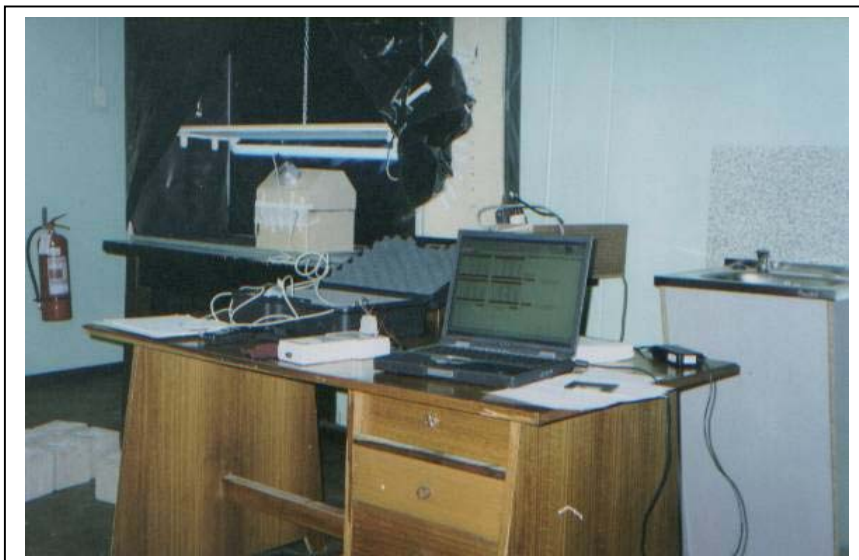
FIG. 6.10. Imagen general ensayo medición de la radiación reflejada. FUENTE. Elaboración propia, 2004.
