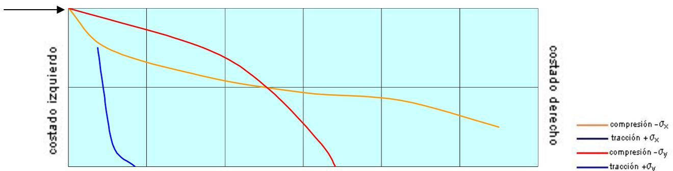
Fig. 5.8 Trayectorias de los valores de tensión máxima en un muro de dos por seis metros. Compresión horizontal, tracción horizontal y tracción vertical.
