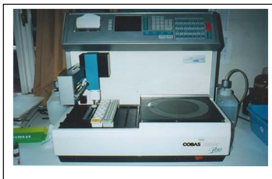
Fig. 2 Equipo analizador Cobas® para la determinación sanguínea de GSH-Px.
