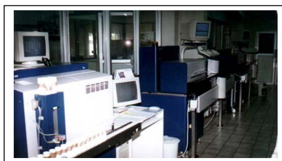
Fig. 4 Equipo Fossomatic para el recuento electrónico de células Somáticas (Laboratorio Calidad de Leche, Cooprinsem, Osorno).
