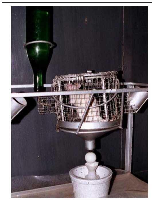
Foto N° 2. Caja metabólica y accesorios necesarios para la obtención de muestras de orina.
