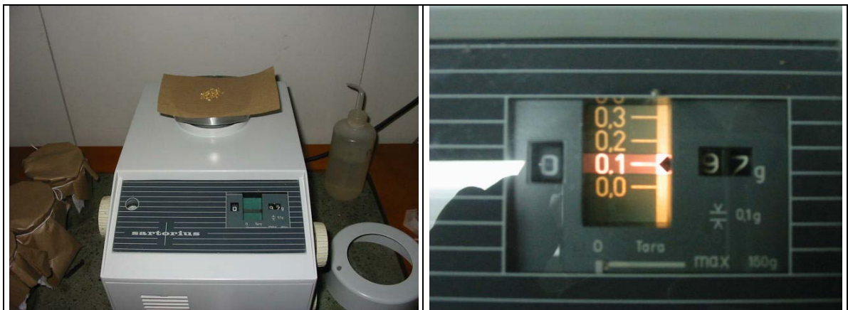
Figura 3. Pesa utilizada para el análisis físico de las semillas; a la izquierda se muestra la pesa propiamente tal, con un grupo de semillas; a la derecha un acercamiento del área de lectura de la información.
