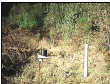
Figura 3. Pluviógrafo HOBBO Event y Totalizador
