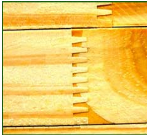
Figura 1. Ejemplo típico de unión dentada por sistema americano.
