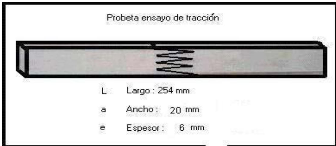
Figura 8. Dimensiones de las probetas para tracción
