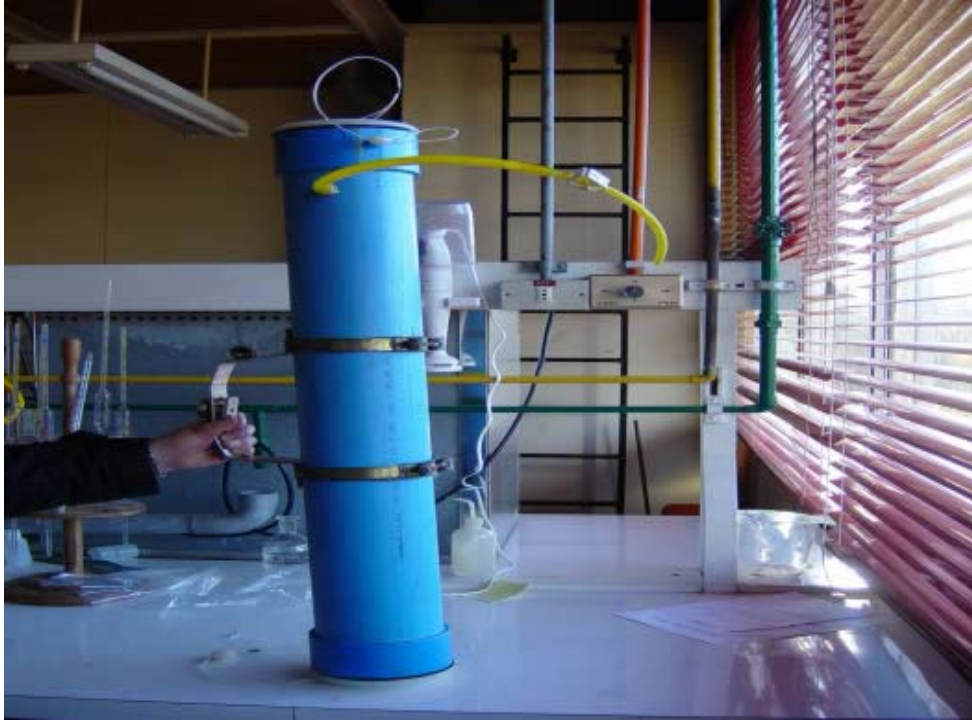
FOTO N°5 : Botella Niskin, con la cual se tomaron las muestras de agua de mar de profundidad media y fondo.
