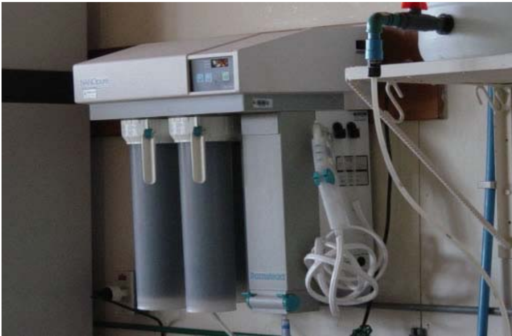
FOTO N°4 : Equipo de Purificación de agua, para obtener agua Suprapur, libre de iones y minerales.
