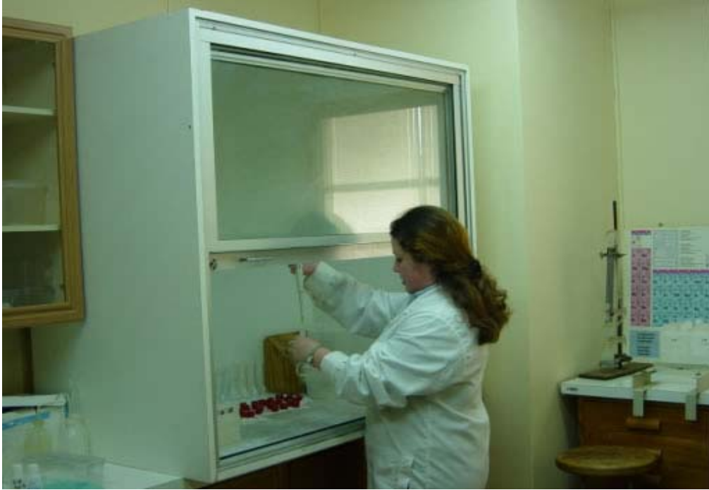
FOTO N°3 : Cámara de Flujo Laminar, donde se preparaban las muestras de agua de mar.
