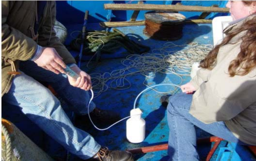
FOTO N°1 : Equipo de Filtración de teflón que se utilizó para filtrar las muestras de agua de mar luego de ser tomadas en los lugares de muestreo.
