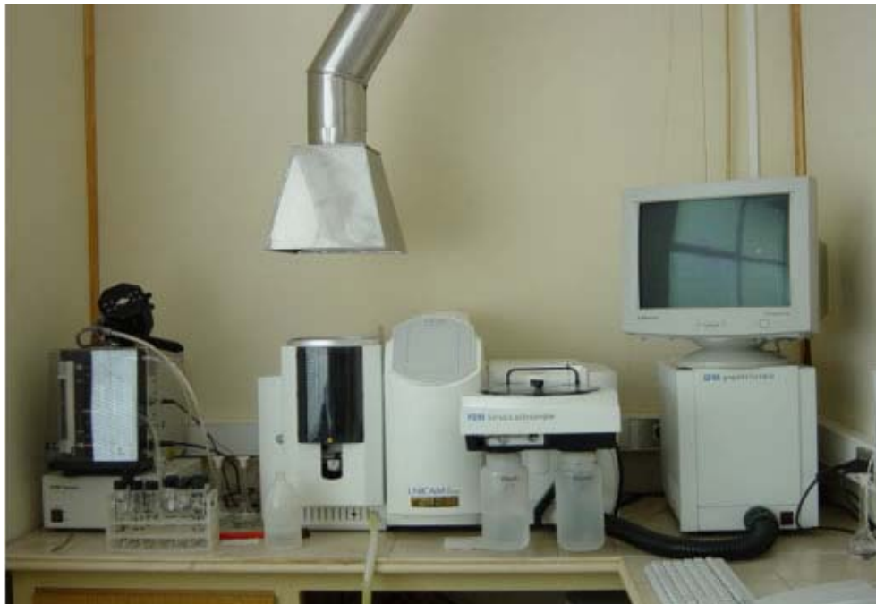
FOTO N°2 : Equipo de Espectrometría de Absorción Atómica Unicam , modelo m-5.
