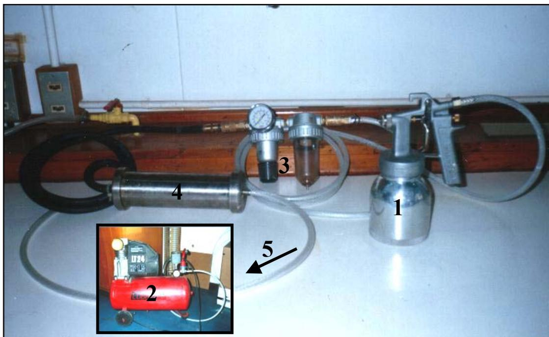
(1) Pistola atomizadora (SAGOLA), (2) Compresor de aire (SQUARE), (3) Medidor de presión (SAGOLA), (4) Filtro de aire de lana de vidrio, (5) Conexión al compresor.
