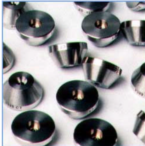
Fig.32 Diseño de tobera “tipo23” [8]
