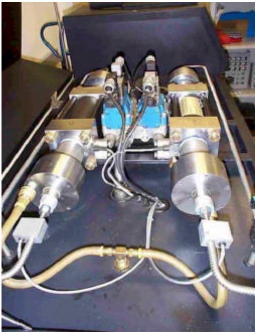
Fig.52 Intensificador de presión doble (Izquierda.) de 380Mpa y 37Kw, bomba de émbolos triple 240Mpa y 15Kw (Derecha) [19]
