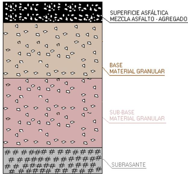
FIG.2 - ESQUEMA PAVIMENTO ASFALTICO
