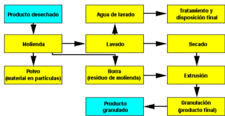
Figura 3. Esquema reciclaje mecánico del PVC.
