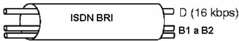
Fig. 2.4.5.2.1. Esquema de combinación ISDN BRI. [Etsi,1990]
