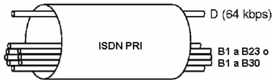
Fig. 2.4.5.2.1. Esquema de combinación ISDN PRI. [Etsi,1990]
