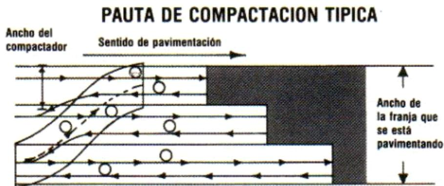
Juntas transversales: Las juntas deben comprobarse con regla para asegurar su regularidad y alineación. En la junta debe emplearse un exceso de material, compactándola, descansando sobre la superficie previamente terminada y apoyando unos 15 cm de una rueda sobre la mezcla recién extendida.
