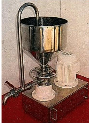
Planta de Emulsiones Asfálticas El Objeto de la Planta de emulsiones asfálticas, es la de obtener una muy buena calidad de emulsión y a un costo competitivo. Para logra una buena calidad de emulsión asfáltica es necesario: calibrar presiones, temperaturas y caudales ya sea para el asfalto como para la fase acuosa.
