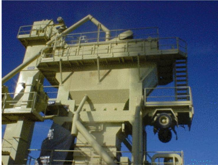
Compuertas de descarga: cada silo posee dos compuertas de descarga independientes, lo que permite una mejor carga de cualquier tipo de vehículos.
