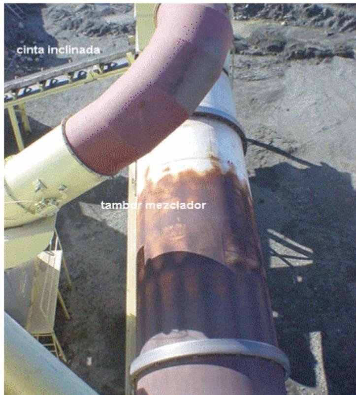
El diseño del tambor mezclador es de flujo paralelo. El tambor se divide en dos partes divididas por una pantalla. En la primera parte los áridos son secados y calentados a través de un sistema de canales y peinetas que producen una cortina (cascada) de material que atraviesa la llama. En una segunda parte el material granular ya seco y caliente es mezclado con el asfalto produciéndose la mezcla que después es descargada al elevador.
