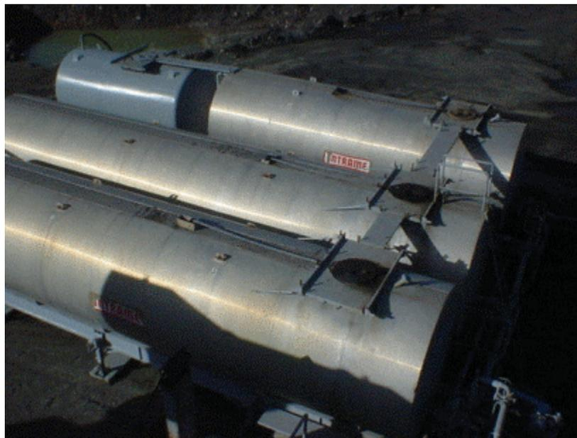
Filtro de mangas Es un tipo de filtro fabricado para minimizar y controlar las emisiones de material particulado desde el tambor. Este sistema en seco, para capturar las partículas en suspensión utiliza mangas de nomex que en total suman 360. El polvo se deposita sobre las mangas en capas, cae de las mangas por una variación de presión que produce un cambio en la forma de la manga, con lo que el polvo adosado se desprende.
