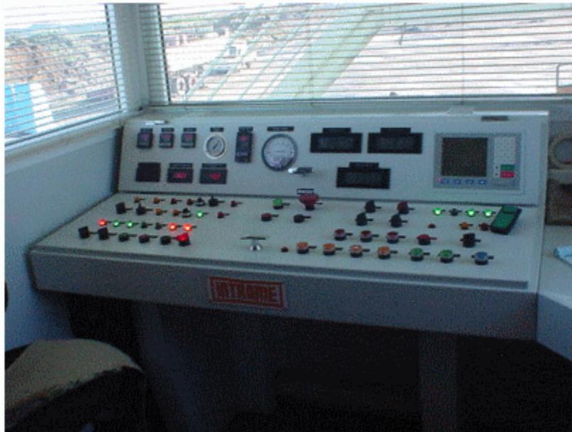
Control de silos: panel de control que permite seleccionar el silo de almacenamiento y la carga de los camiones. Además permite bloquear los silos y sellarlos.
