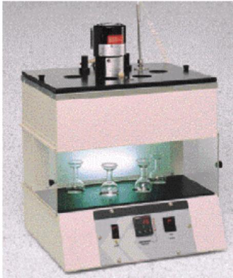
Se utiliza el orificio universal para lubricantes y materiales destilados con tiempo de flujo, mayor a 32 seg. Y se utiliza el Furol para materiales residuales con tiempo de flujo mayor de 25 seg. el viscosímetro tiene que estar en lugares donde no hayan corrientes de aire o cambios de temperatura muy bruscos ni menos contaminación.
