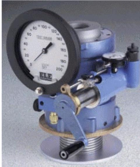
En este procedimiento se gira la bomba de desplazamiento hasta que la presión sea 690 kPa. Se lee el dial Ames y se registra en unidades de 0.25 mm el desplazamiento de la probeta.
