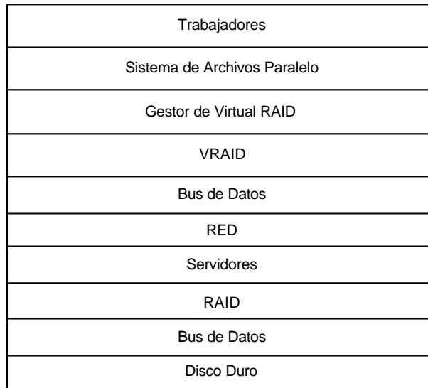
Figura 14.3 Bloques de un sistema de archivos distribuido y paralelo con redundancia de datos.
