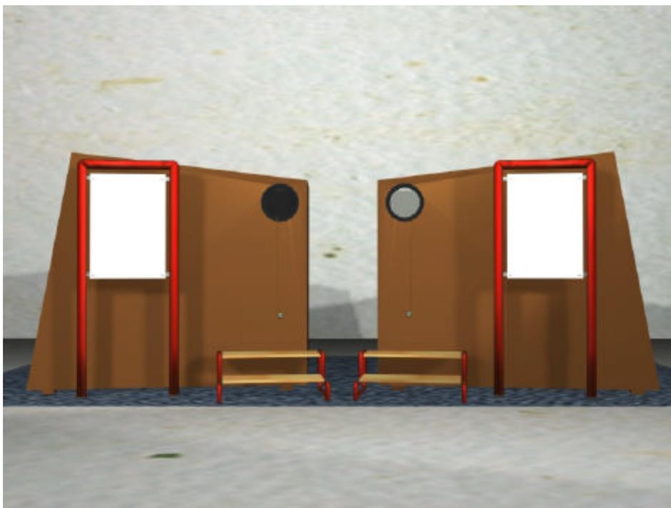
Las dos cámaras tienen exactamente la misma forma y al interior de ellas hay una campana. Difieren en el material que recubre las paredes por dentro, siendo la de la izquierda la “cámara absorbente” por estar recubierta de material poroso (lana mineral cubierta de paño hilac) y la de la derecha por material reflectante (cerámica de baño).
