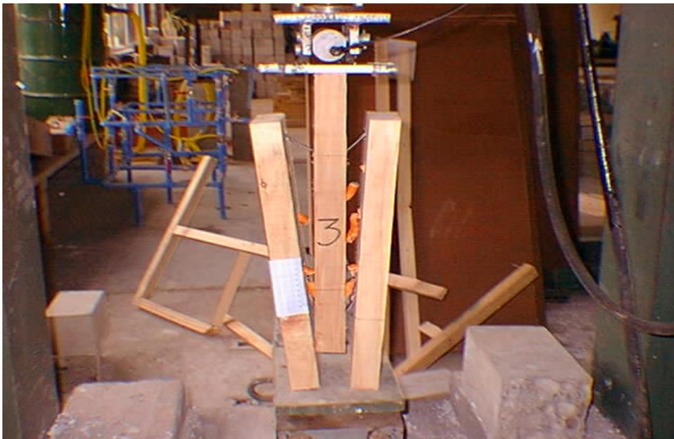
Fig.: Probeta 2 con tres conectores, después del ensayo se observa los conectores cortados, y sólo sujetos con los clavos inferiores.
