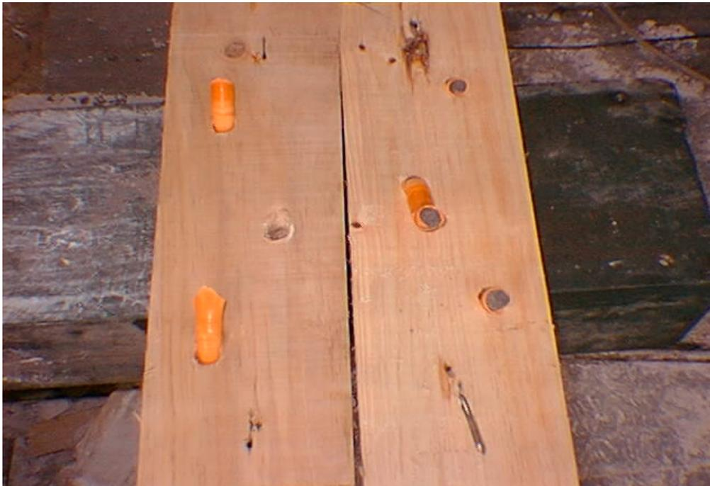
Fig.: Probeta 3 con tres conectores, se observa el desplazamiento de los conectores de las piezas.
