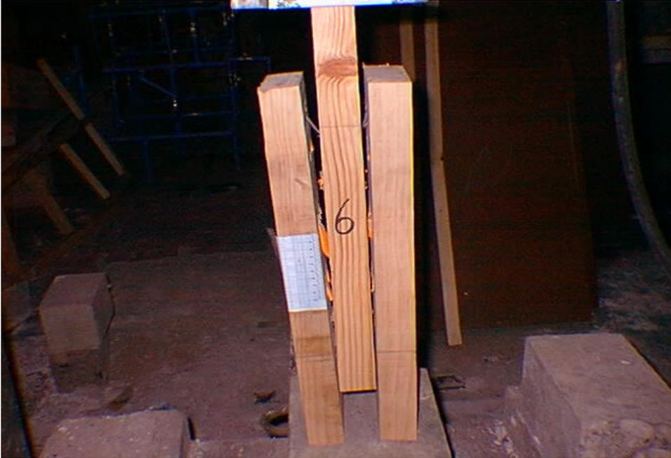
Fig.: Probeta 1 con seis conectores, durante el ensayo.
