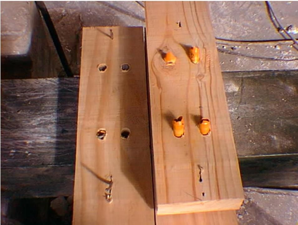
Fig.: Probeta 2 con cuatro conectores, después de romperse todos los conectores.
