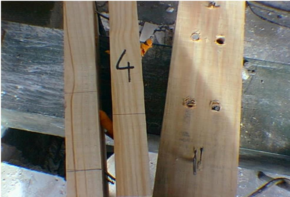
Fig.: Probeta 1 con cuatro conectores, después de realizarse el ensayo.
