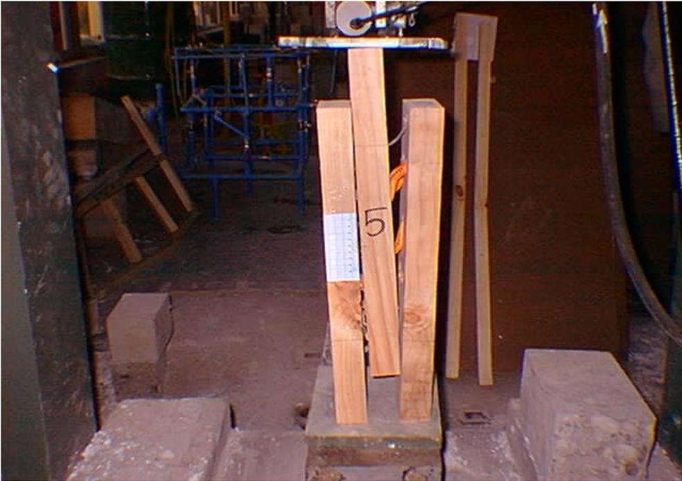
Fig.: Probeta 1 con cinco conectores, durante el ensayo, se observa como se cortan los conectores
