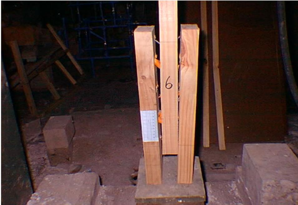
Fig.: Probeta 2 con seis conectores, durante el ensayo, se visualiza como se van cortando los conectores.
