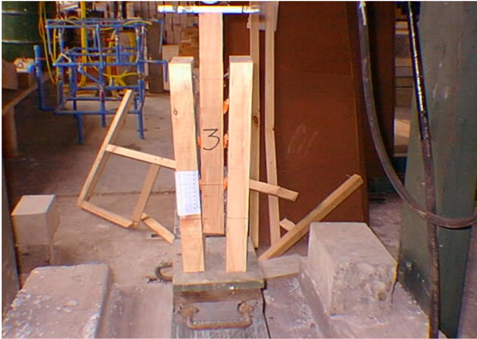
Fig.: Probeta 2 con tres conectores, durante el ensayo.
