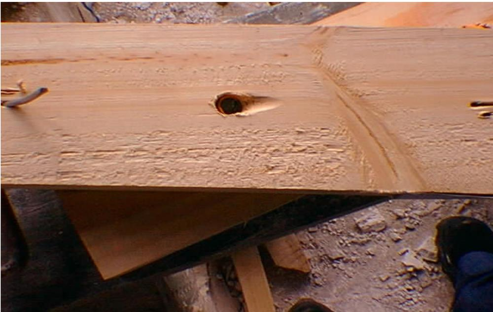
Fig.: Probeta 2 con dos conectores, después del ensayo, se observa el aplastamiento de la pieza.
