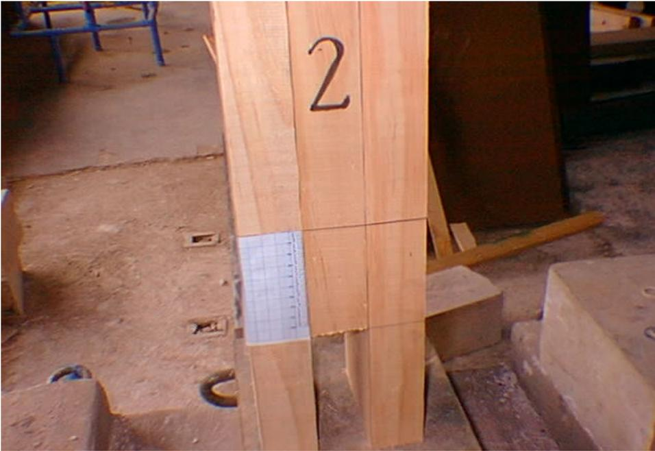
Fig.: Probeta 1 con dos conectores, antes de realizarse el ensayo.
