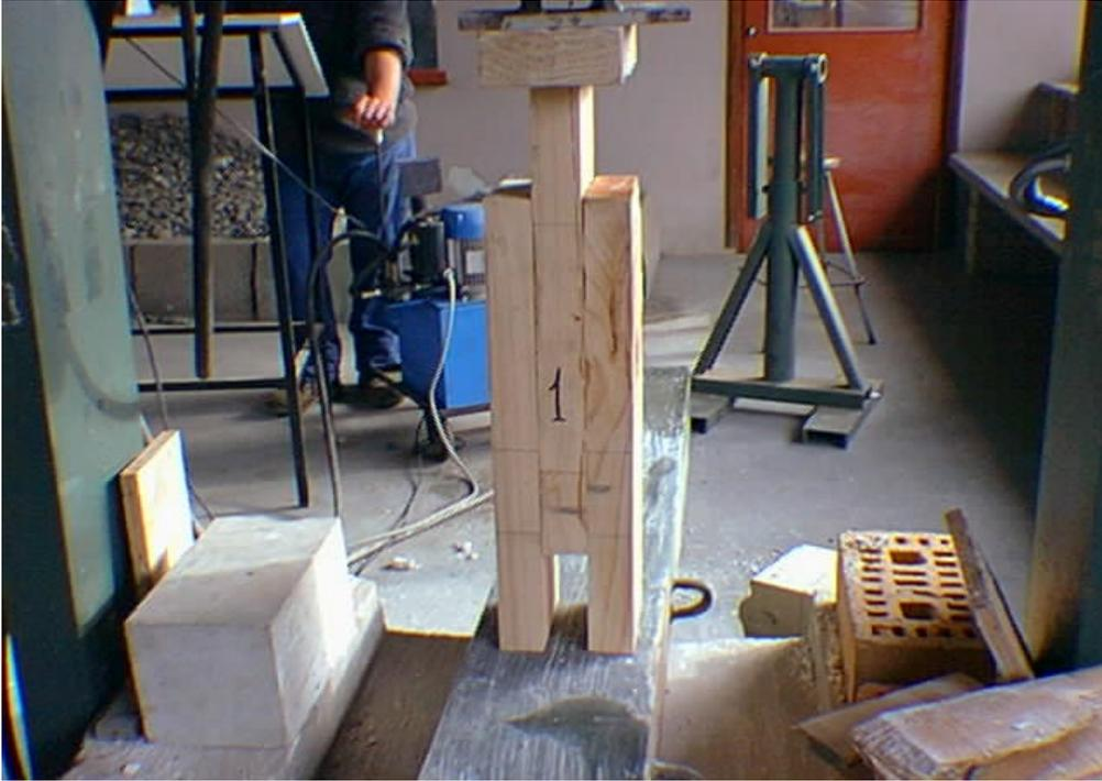
Fig.: Probeta 1 con un conector, antes de ser ensayada.
