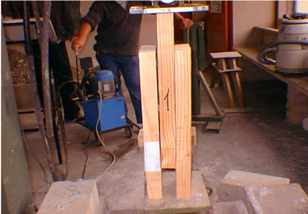
Fig.: Probeta 3 con un conector, durante el ensayo.
