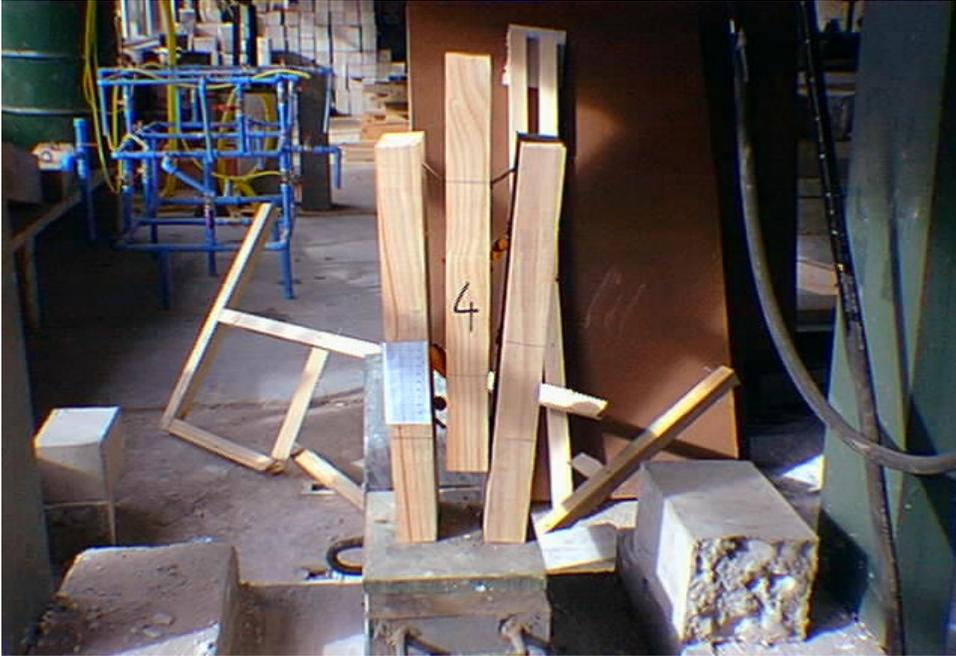
Fig.: Probeta 2 con cuatro conectores, justo antes de romperse el último conector.
