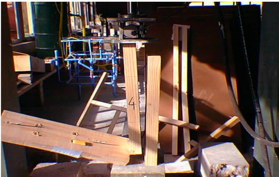
Fig.: Probeta 3 con cuatro conectores, cuando se rompen los conectores y se desprende una de las piezas laterales.
