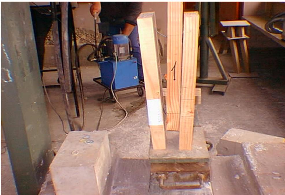
Fig.: Probeta 2 con un conector, después de realizado el ensayo de esta probeta.
