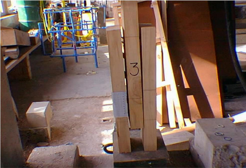
Fig.: Probeta 1 con tres conectores, realización del ensayo, se observa como se comienzan a doblar los conectores antes de romperse.
