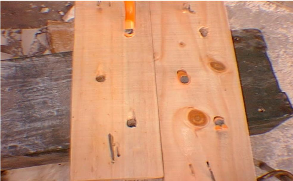
Fig.: Probeta 1 con tres conectores, se observa el aplastamiento y deslizamiento producido.
