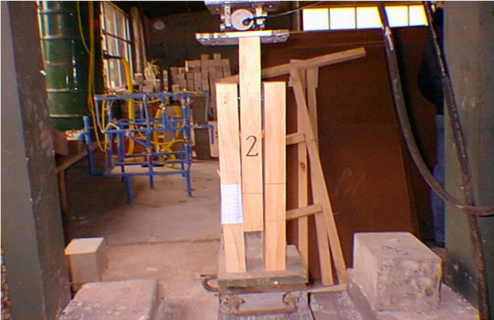
Fig.: probeta 2 con dos conectores, durante el ensayo se observa como comienzan a doblarse los conectores antes de llegar a cortarse.
