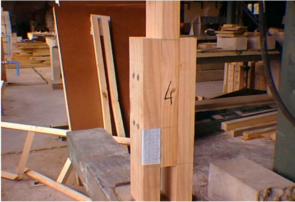
Fig.: Probeta 1 con cuatro conectores, antes de realizarse el ensayo.
