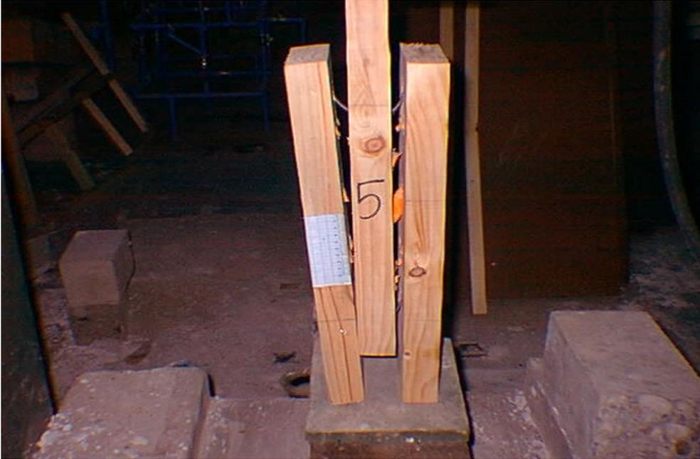
Fig.: Probeta 3 con cinco conectores, durante el ensayo, se observa como se cortaron los conectores
