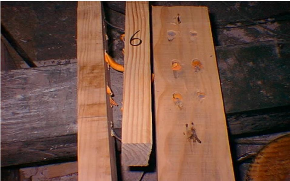
Fig.: Probeta 3 con cinco conectores, después del ensayo, los conectores se deslizan y las piezas sufren aplastamiento.
