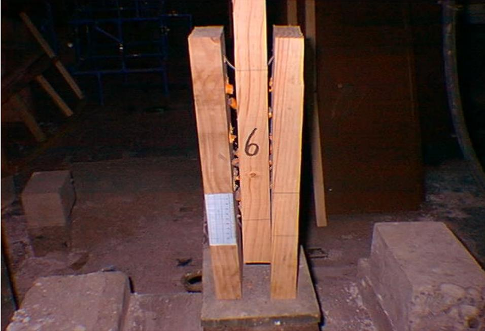
Fig.: Probeta 3 con seis conectores, durante el ensayo, se observa como se van rompiendo los conectores.
