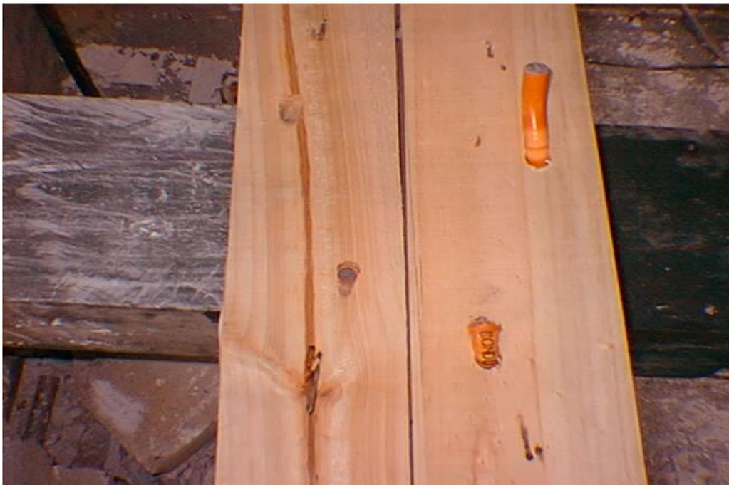
Fig.: Probeta 3 con dos conectores, se visualiza el deslizamiento de los conectores.
