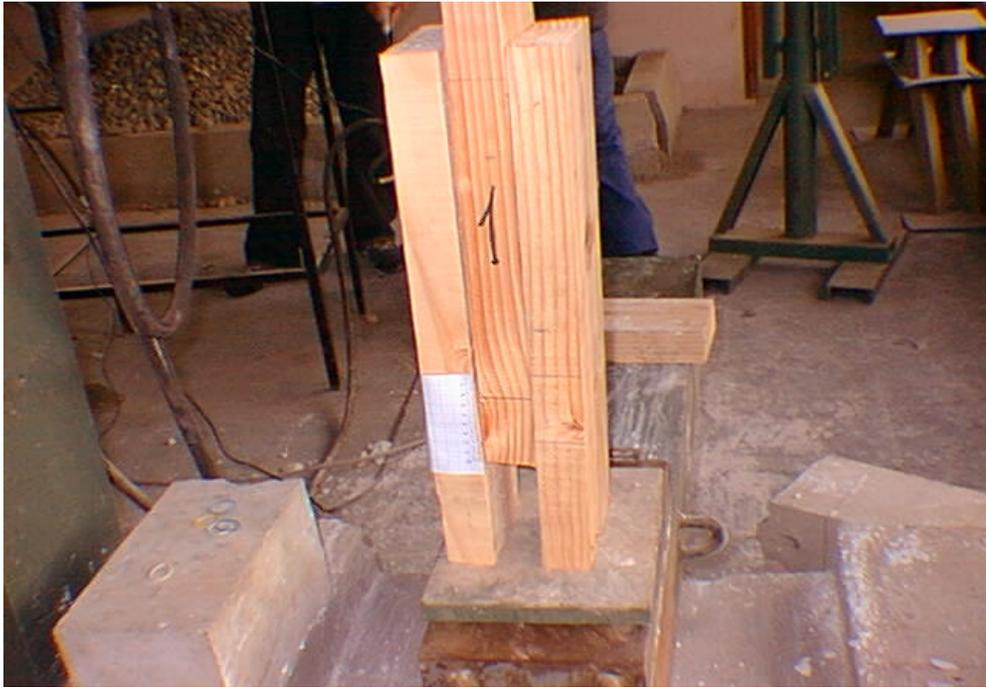
Fig.: Probeta 2 con un conector, durante el ensayo.
