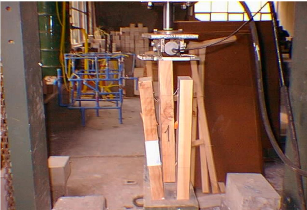
Fig.: Probeta 1 con un conector, después de sometida a ensayo.
