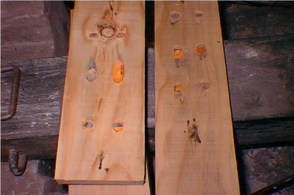
Fig.: Probeta 1 con seis conectores, después del ensayo.
