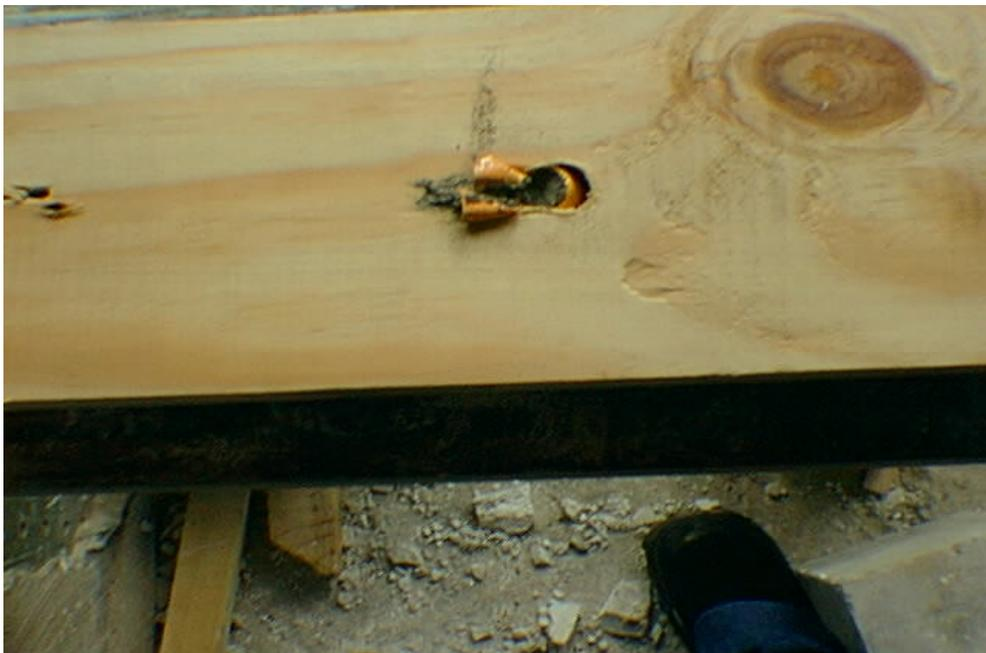
Fig.: Probeta 3 con un conector, se muestra el aplastamiento después de realizado el ensayo.
