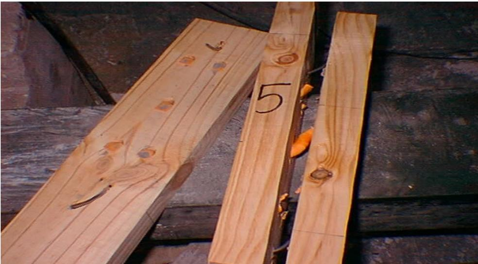
Fig.: Probeta 1 con cinco conectores, después del ensayo se observa como se rompieron los conectores
