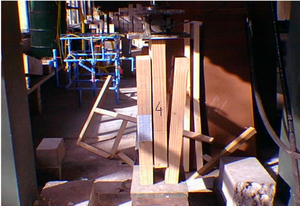
Fig.: Probeta 3 con cuatro conectores, durante el ensayo.
