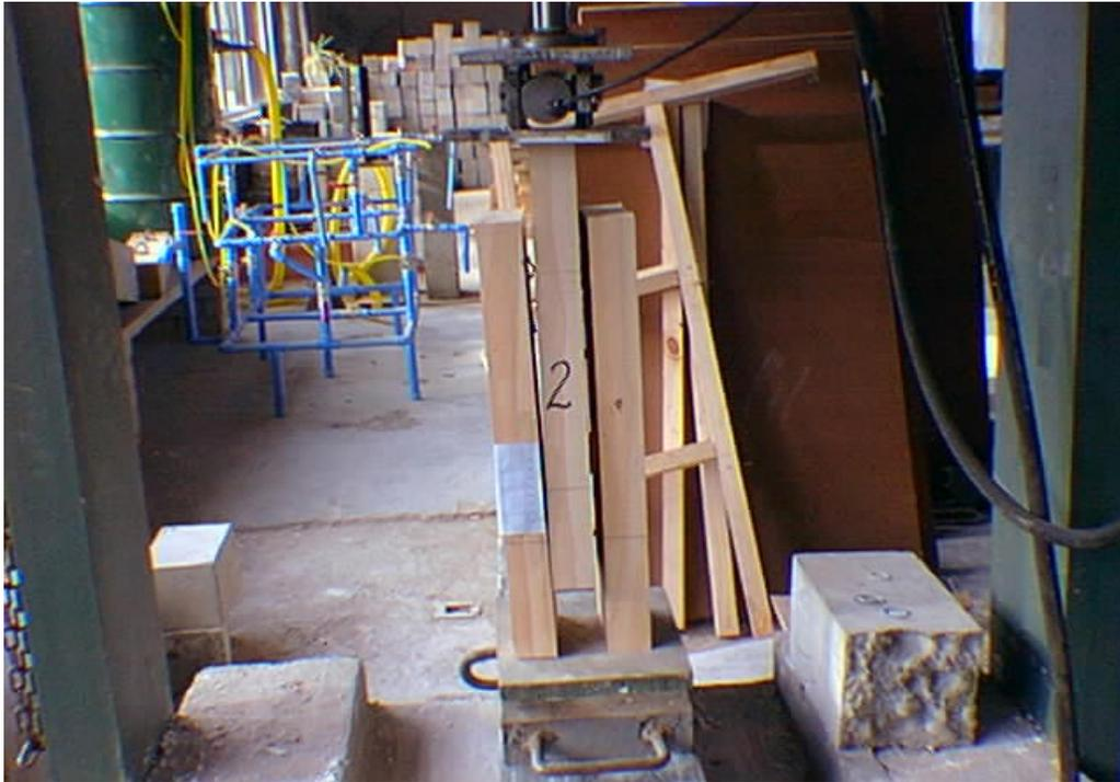
Fig.: Probeta 3 con dos conectores, durante la realización del ensayo.
