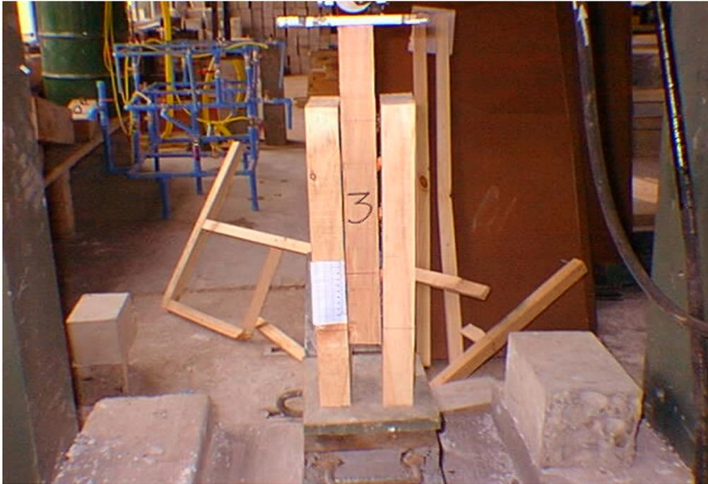
Fig.: Probeta 3 con tres conectores, durante el ensayo.
