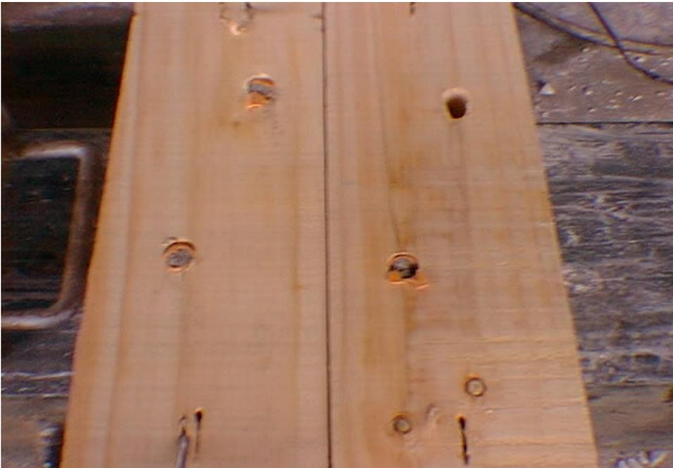
Fig.: Probeta 1 con dos conectores, después de realizado el ensayo, puede visualizarse como se cortaron los conectores.
