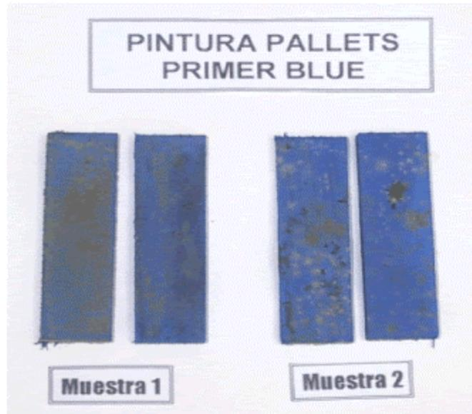
Figura c. Aspecto que presentan las probetas con la **pintura y formulación de pintura**, una vez concluido el ensayo (4<sup>a</sup> semana). Izquierda probeta tratada con la pintura (Muestra 1). Derecha probeta tratada con la formulación de pintura al 1,4% (Muestra 2). Ambas muestras fueron inoculadas con los hongos citados anteriormente.
