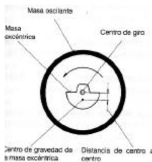
Fig 32. Generación de la fuerza centrífuga
