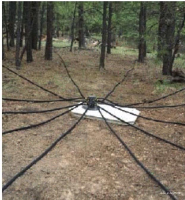
Figura 8.3: Pipetas reductoras de ruido acopladas a un micrófono infrasónico.
