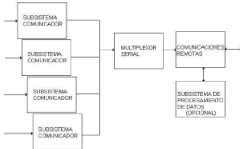
Figura 9.6: Esquema de los componentes de una estación receptora de infrasonidos [35].
