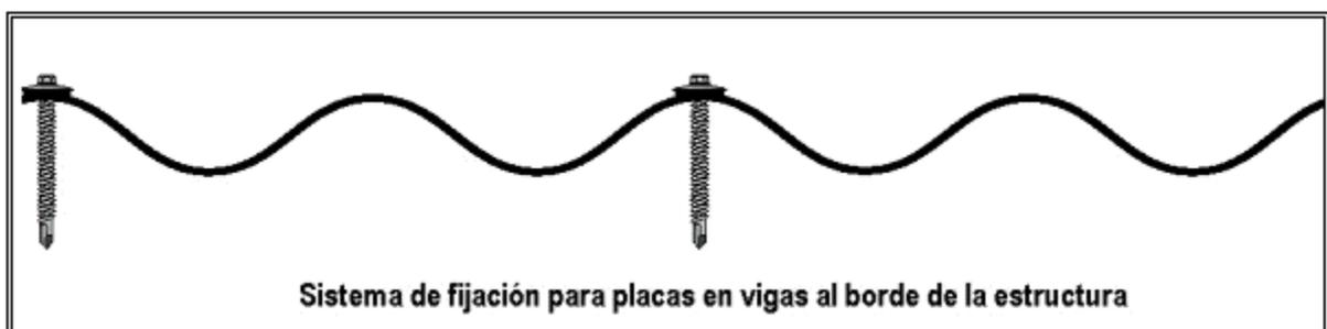
Fig. N° 82a. – Fijación de placas onduladas en vigas intermedias.
