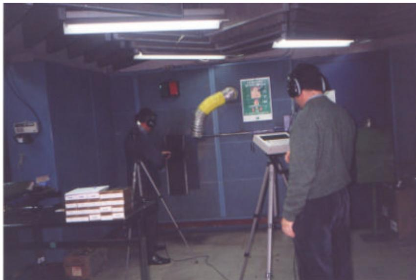
*Imagen 2: Medición in situ del ruido impulsivo de armamento.*
