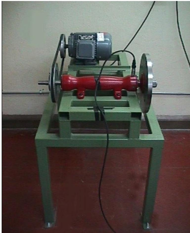
Fig. 7.1. Banco de prueba para ensayo de vibraciones en rodamientos.
