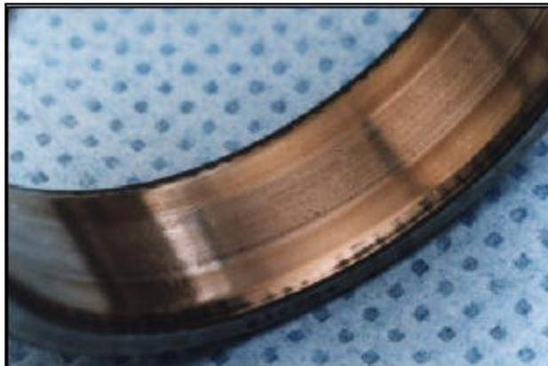
Fig. 6.7. Rodamiento con desgaste producido por partículas abrasivas
