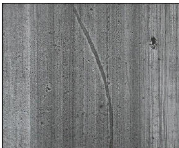
Fig.6.11. Rodamiento con indentación producto de una partícula
