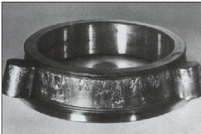
Fig. 6.15. Rodamiento con flaking (fatiga del metal)
