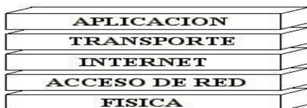
Fig.2-1-. Las capas del TCP/ IP
