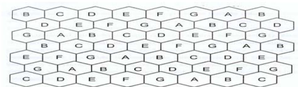
**Fig. Celdas con reutilización de frecuencia, K= 7**
