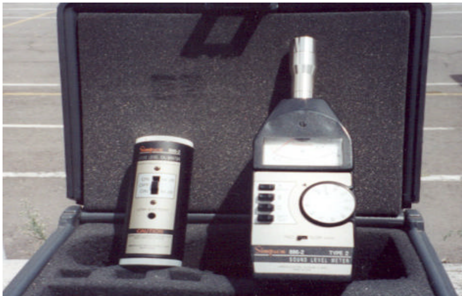
Fig 9. Sonómetro Simpson, utilizado en la Dirección de Medio Ambiente
