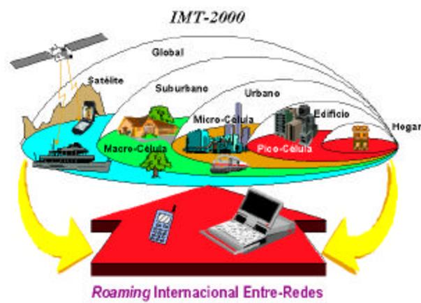
Figura 3. Cobertura global de IMT-2000 a través de una estructura jerárquica de celdas y el uso combinado de componente satelital y terrestre
