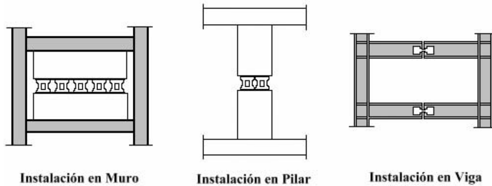
Figura 2.2 Método de aplicación de los amortiguadores Honeycomb.
